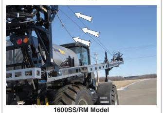
FIG. 79 CABLES SLACK
