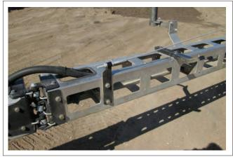
FIG. 35 BOOM BREAK-AWAY JOINT (TYPICAL)
