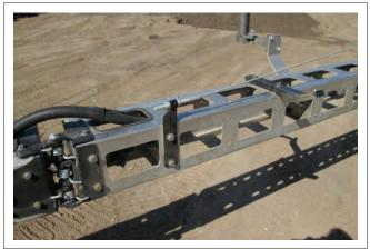
FIG. 94 BOOM BREAK-AWAY JOINT (TYPICAL)
