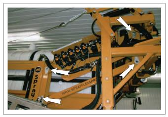
FIG. 83 HEIGHT LINKAGE PINS
