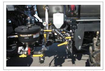
FIG. 13 CHEMICAL CIRCUIT PRESSURE GAUGE
